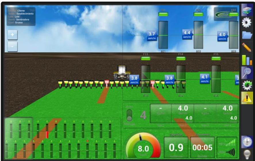
**7.2 Zoom de sensores:** Puede visualizar en zoom, los sensores de caída, los sensores adicionales (si estuvieran instalados) y las alarmas instantáneas.
