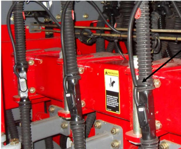
Precintar a la salida, para que no se fatigue el cable; en la unión con el sensor.
