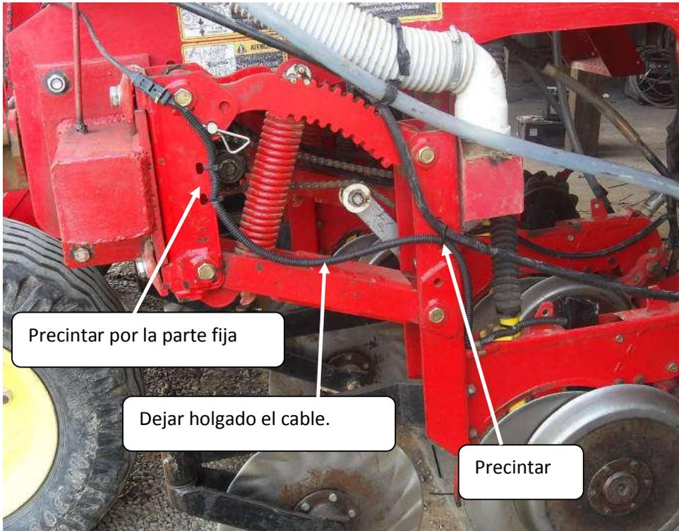
c) Instalación de sensores de semilla a chorrillo y/o sensores de fertilizante, Sobre manguera.
