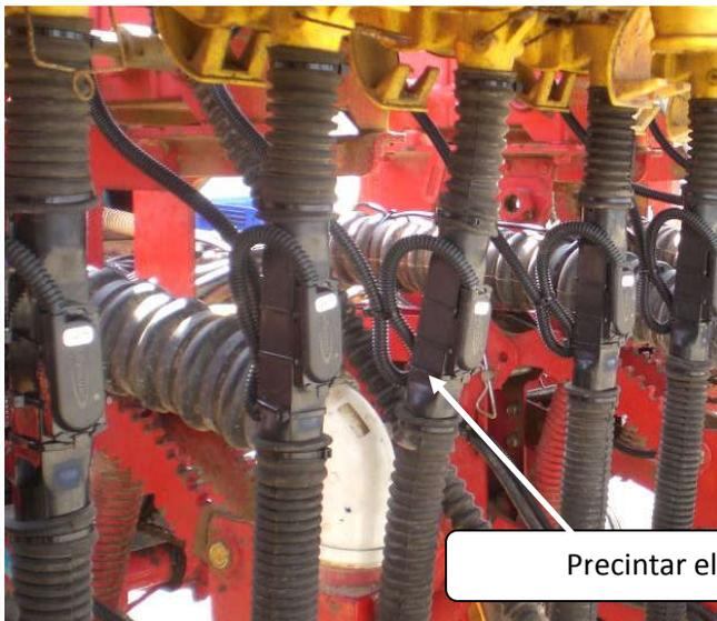
Dar una curva hacia abajo, dejando suficiente longitud, para facilitar la extracción del sensor.
