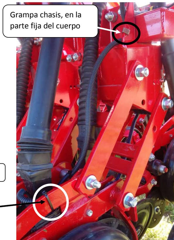
b) Precintado del cable, sobre el cuerpo de siembra, en sembradoras de paralelogramo corto (mayormente a placa/siembra gruesa).
